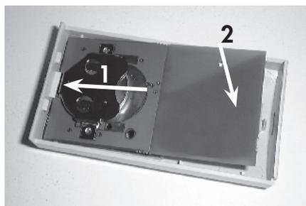
Insérer la carte électronique dans le boîtier amovible, en respectant le sens de montage et en veillant à la positionner sous l'ergot.
